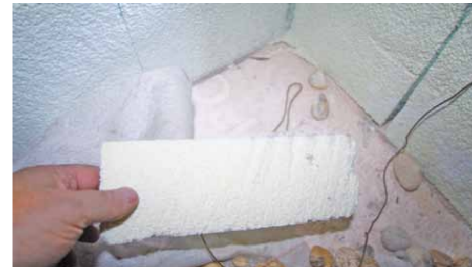
Baufirmen werden oft durch die Färbung getäuscht und gehen von XPS-Platten aus. Tatsächlich sind EPS-Platten eindeutig an den Schaumkügelchen erkennbar.
